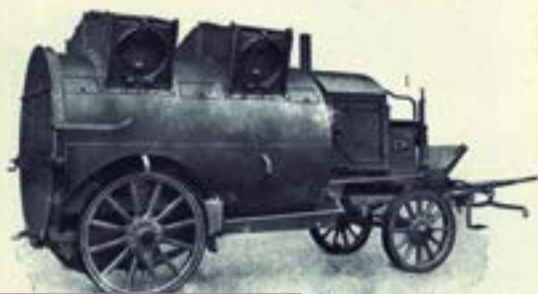
Jeden z nejstarších typů popelářských vozů s tzv. bezprašným vyprazdňováním z konce 19. století.
