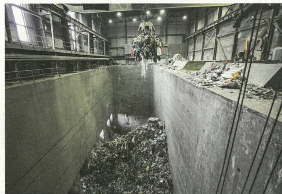
Zcela naplněný bunker by jednomu kotli vystačil zhruba na týden.
